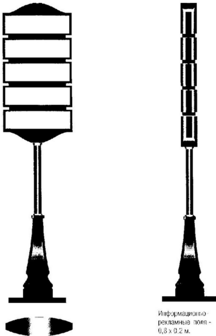
Рис. 2. Информационный указатель типа "линза", представляющий собой вертикальную опору, в верхней части которой располагается световой короб (стенд) с размером каждой информационной плоскости 0,8x1,2 м или с наборным информационным полем с общим размером 0,8x1,2 м
